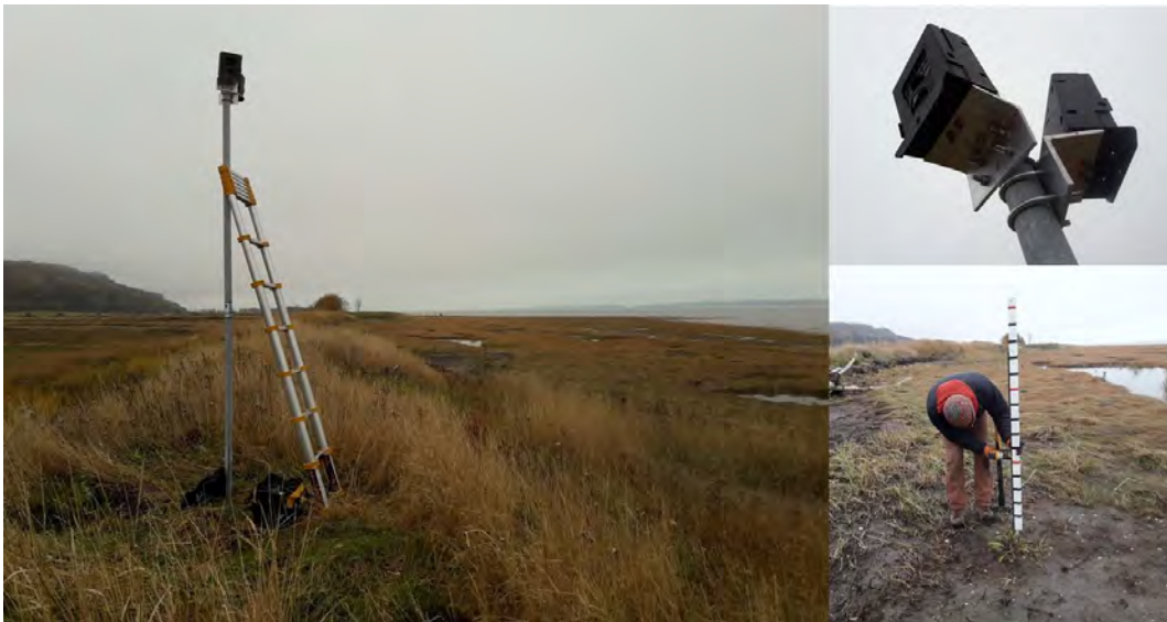
Figure 22. Caméras de suivi et règle de niveau d'eau à Saint-André
