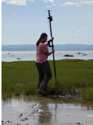
Figure 19. Exemple de levé topographique au DGPS Arrow Gold.
