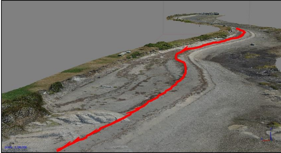
Figure 42. Perspective en 3D de l'orthophotographie et du modèle numérique d'élévation générés par PhotoScan.
