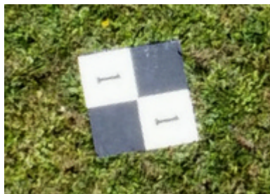
Figure 19. Exemple d'une cible. La coordonnée est prise au centre des carrés noirs et blancs, à l'intersection à l'aide d'un D-GPS Arrow Gold.
