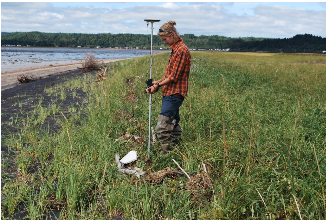
Figure 9. Montage de l'antenne DGPS en mode stop'n'go. (Joyal, 2011)
