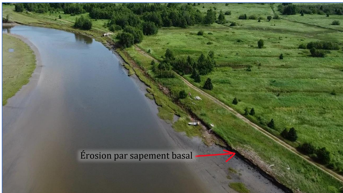
Figure 8. Vue aérienne d'érosion par sapement basal, rive gauche de l'estuaire de la rivière des Petites Bergeronnes (Comité ZIP RNE, 2021).
