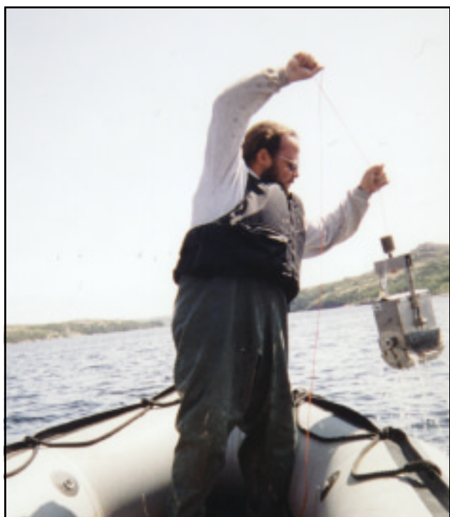
Échantillonnage du substrat à l'aide de la benne.
