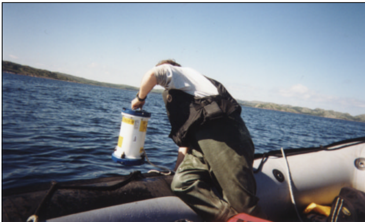
Mise à l'eau du courantomètre.
