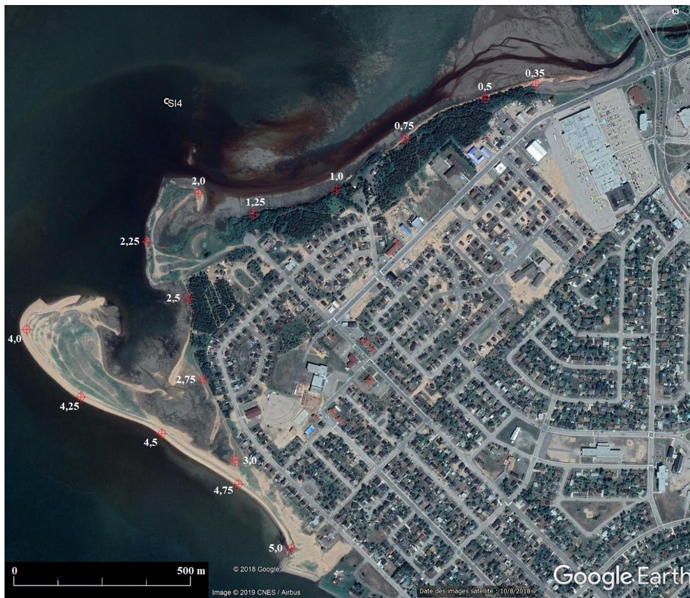
Figure 2.3 Rapport UQAR-2008 – Évolution des rives de Sept-Îles – Position des chaînages de l’UQAR
