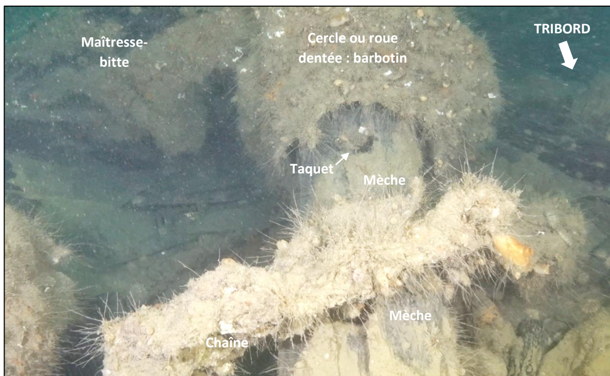
Figure 42 Divers éléments du guindeau (IRHMAS 2021)
