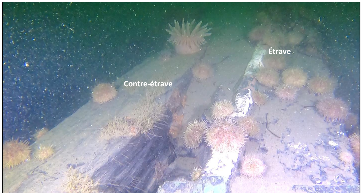
Figure 37 Étrave et contre-étrave (IRHMAS 2021)
