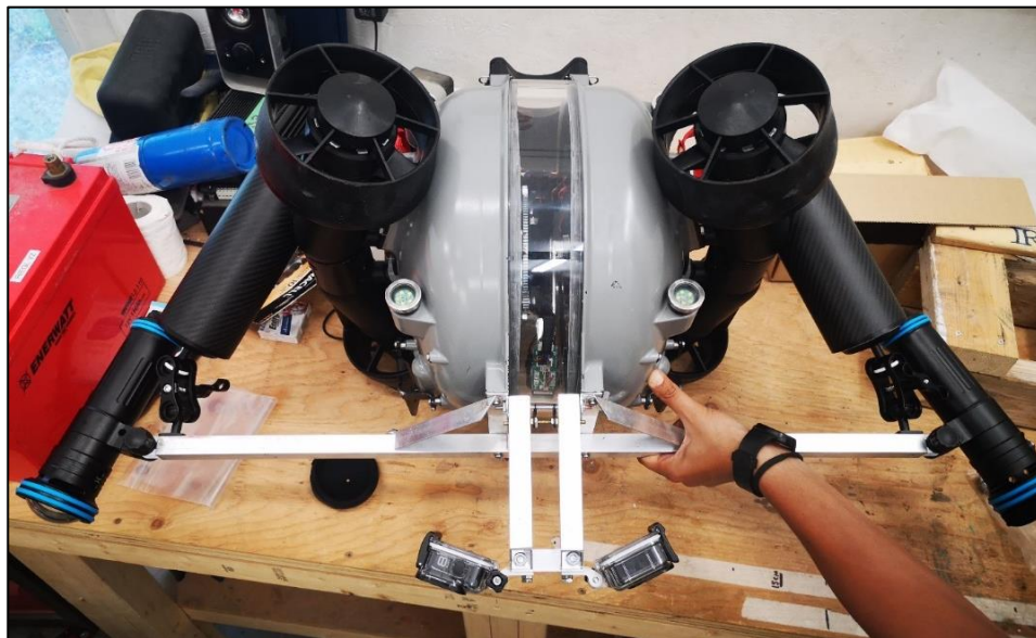
Figure 6 Montage des lampes et des GoPro sur le Deep Trekker (Leclair-Brideau 2021)
