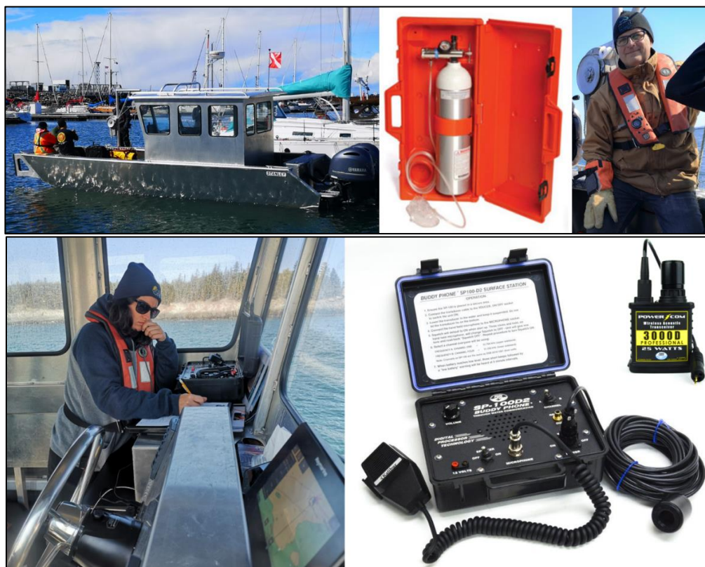
Figure 5. Matériel relié à la sécurité et aux communications : drapeau de plongée ; trousse d'oxygénothérapie et médicale ; console de communication et radio individuelle (IRHMAS 2020 ; https://www.oceantechnologysystems.com/ ).
