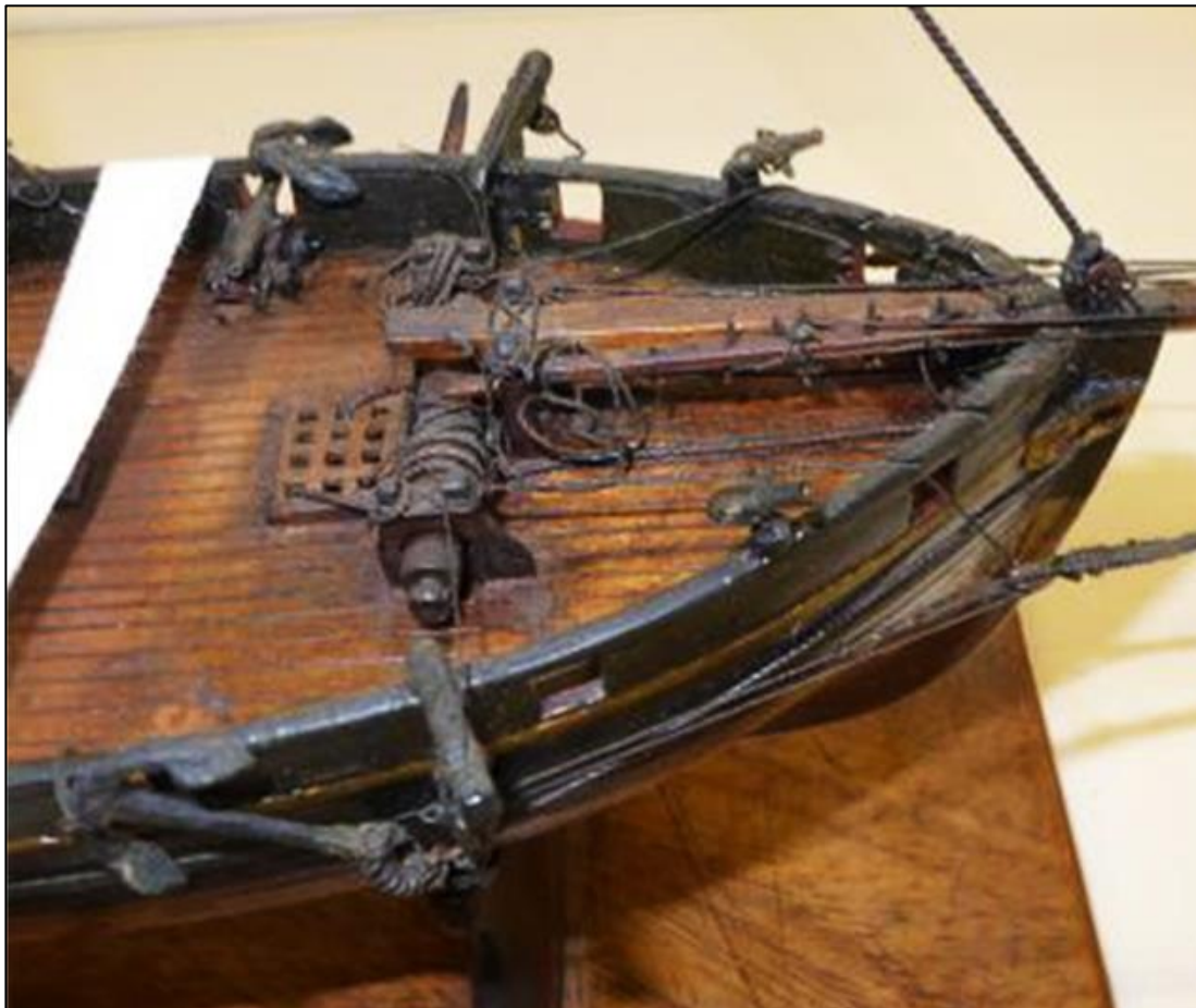
Figure 54. Hypothèse 1 : Exemple de guindeau rattachés au mât de beaupré sur une maquette du XIX e siècle (National Museum Greenwich, Londres).
