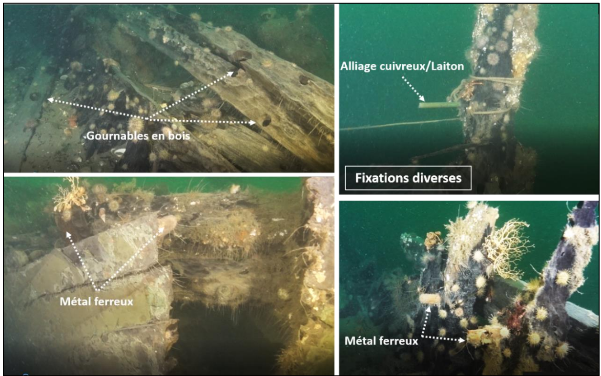
Figure 43. Différents types de fixations rencontrées sur le Scotsman 1 (Laroque 2016).
